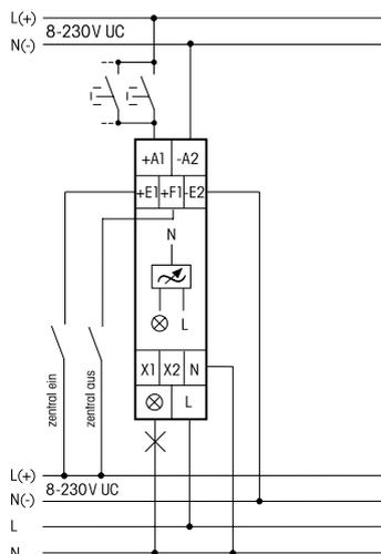
**Funktion 'RTD'** = wie Universal-Dimmerschalter EUD jedoch mit Ansteuerung über zwei Richtungstaster an den zentralen Universalspannungs-Steuereingängen 8. 230V UC.
