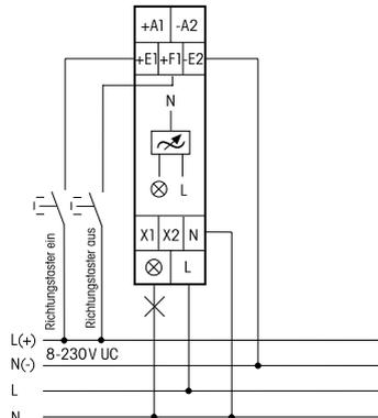
**Funktion 'ESV'** = wie Universal-Dimmerschalter EUD zusätzlich mit Einstellung einer Rückfallverzögerung von 1 bis 99 Minuten. Ausschaltvorwarnung am Ende durch Abdimmen wählbar und einstellbar von 1 bis 3 Minuten. Beide Zentraleingänge aktiv.
