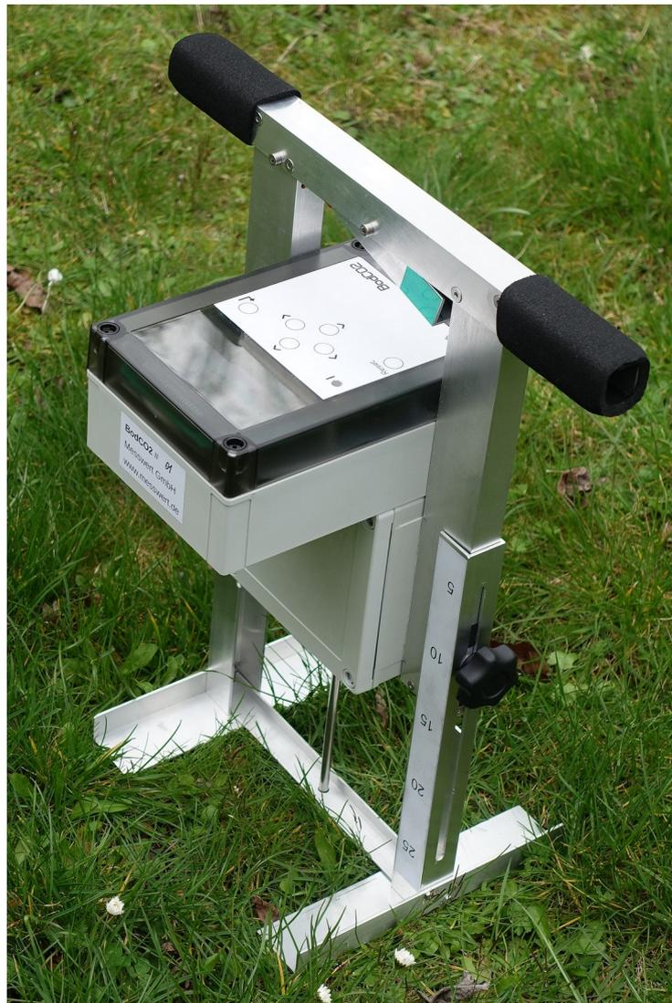
Das BodCO2 in Messposition mit Sonde im Boden
